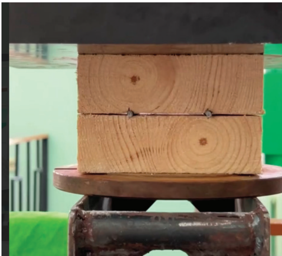
Рис. 1. Вдавливание арматуры в деревянные ламели
