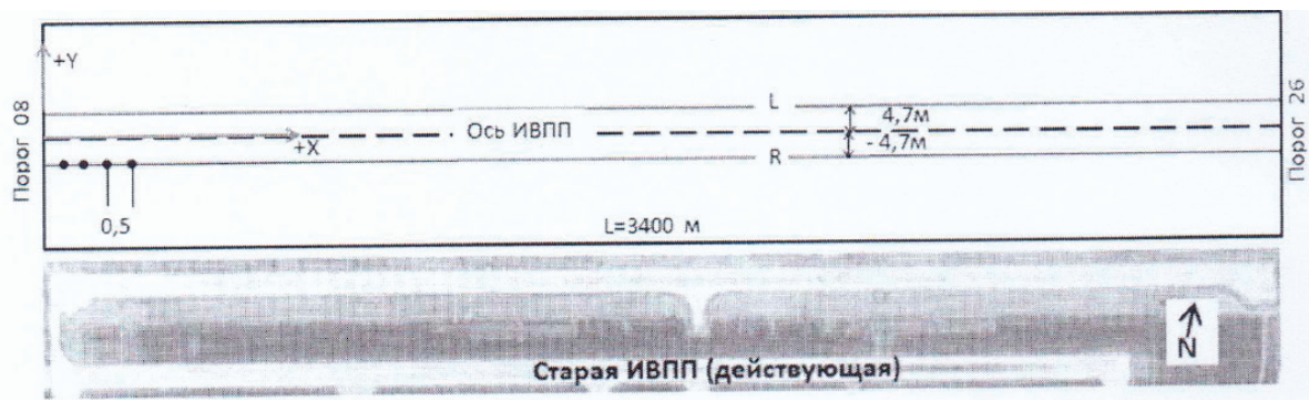
Рис. 2. Схема измерения отметок профилей ИВПП аэродрома «Улан-Удэ» (Мухино)
