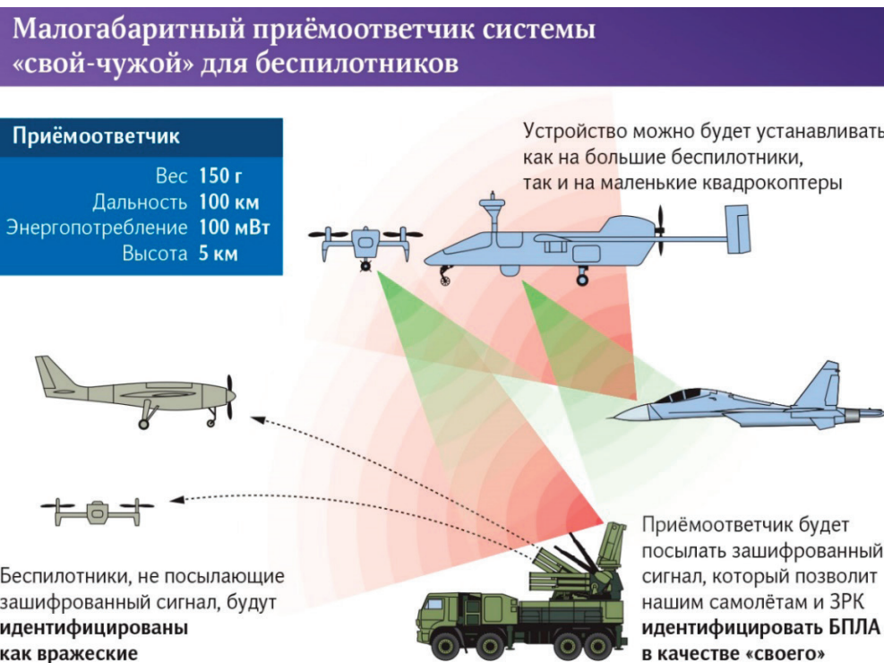
Рис. 1. Принцип работы системы «свой — чужой» [1]
