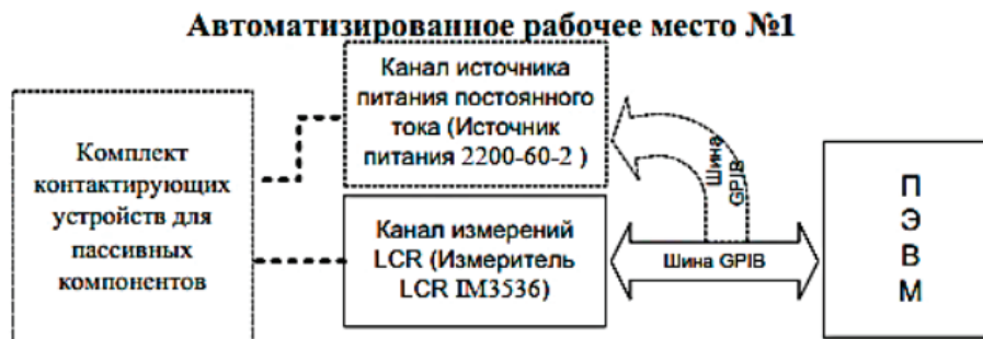
Рис. 2. Структурная схема комплекса ДМТ-220
