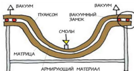
Рис. 1. Схема изготовления детали RTM методом
