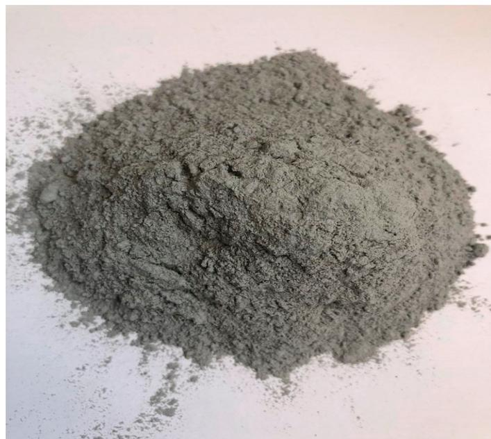
Рис. 3. Молотые отходы камнепиления
