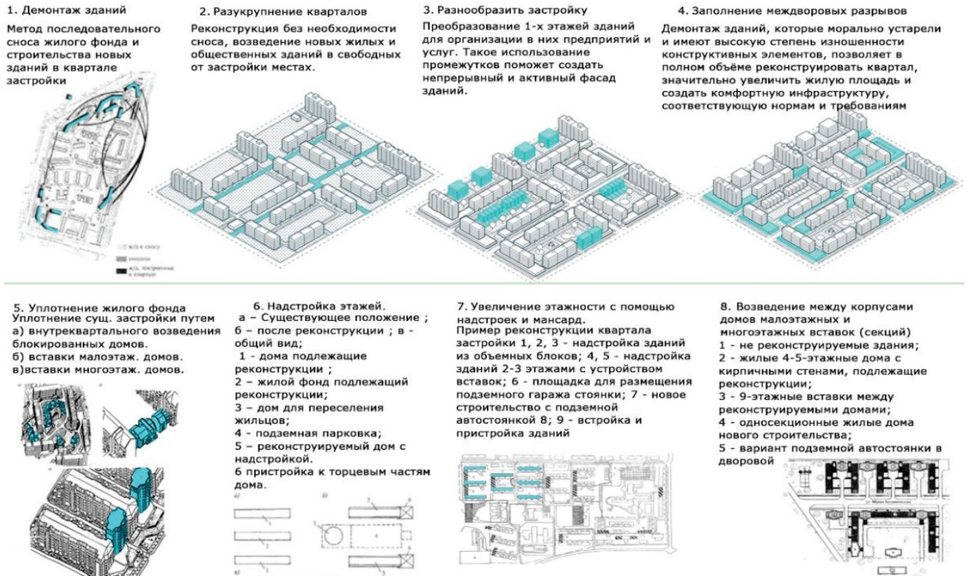
Рис. 3. Виды реконструкции квартала. 1. Полный демонтаж зданий. 2. Разукрупнение квартала. 3. Разнообразивание застройки 4. Заполнение междворовых разрывов. 5. Уплотнение существующей застройки; 6. Увеличение этажности с помощью надстроек и мансард. 7— встройка и пристройка зданий. 8. Возведение между корпусами домов малоэтажных и многоэтажных вставок
