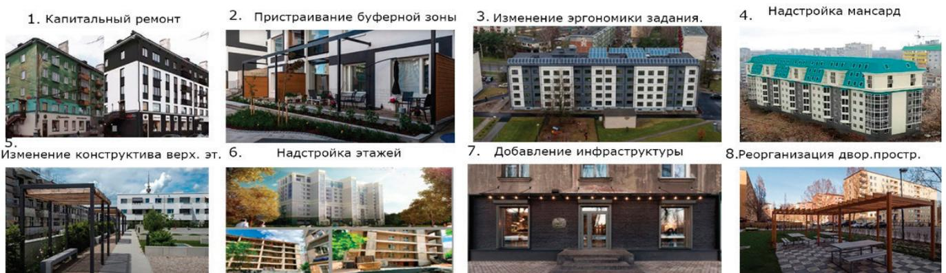
Рис. 4. Существующие направления реконструкции 5-этажной жилой застройки 1960-х годов. 1. Кап. Ремонт, 2. Пристраивание буферной зоны, 3. Изменение эргономики здания. 4. Надстройка мансард, 5. Изменение конструктива крыш. 6. Надстройка этажей, 7. Добавление инфраструктуры на 1-е этажи зданий, 8. Реорганизация дворовых пространств
