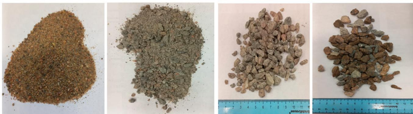
Рис. 1. Заполнители ремонтных эпоксидных композитов: кварцевый песок, отсеvy дробления гранита, щебень гранитный фракции 10 и 20 мм
