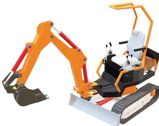
Рис. 8. Цветная 3D-модель экскаватора на базе малогабаритной многофункциональной гусеничной платформы «Танкоград Т-1500»
