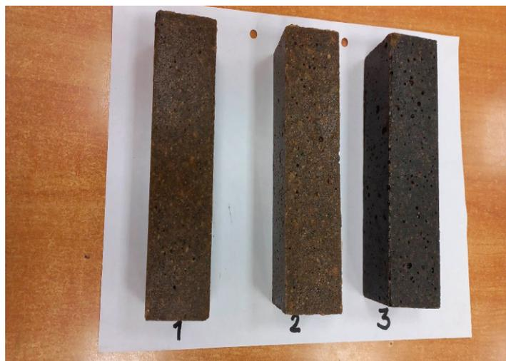
Рис. 2. Образцы-балочки 40×40×160 для определения характеристик модифицированных эпоксидных композитов
