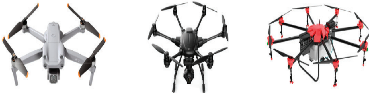
Рис. 1. Дроны коптерного (роторного) типа, слева направо квадрокоптер с 4 винтами, гексакоптер с 6 винтами, октокоптер с 8 винтами [3]
