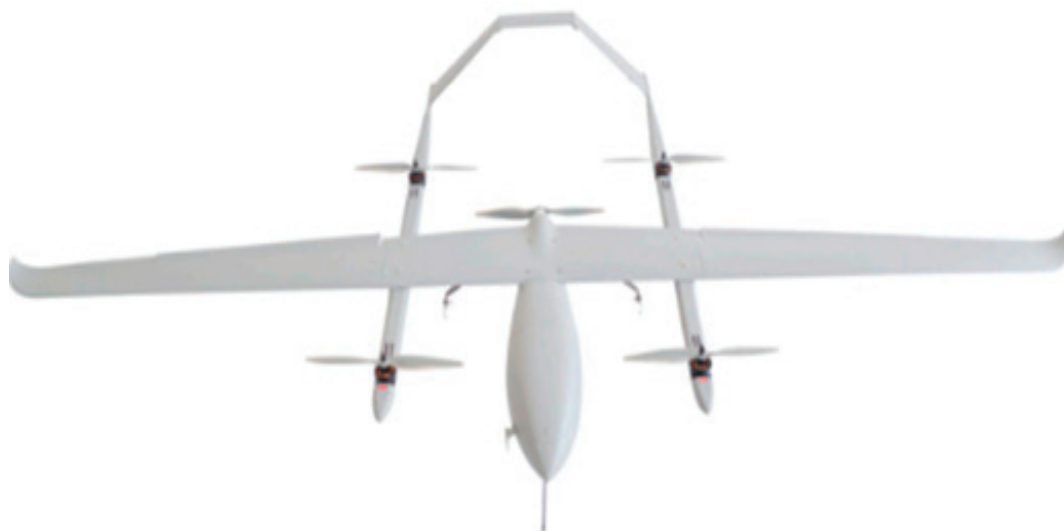
Рис. 3. Дрон гибридного типа (с винтами и крыльями) [1]
