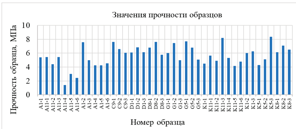
Рис. 5. Столбчатая диаграмма испытаний прочности морского льда на одноосное сжатие
