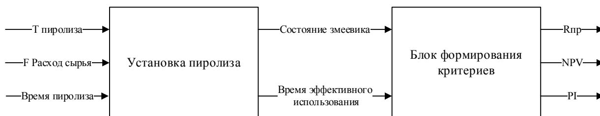
Рис. 1. Системное представление задачи оптимизации процесса пиролиза нефтешлама на основе оценки состояния и производственного потенциала пиролизной установки в виде модели черного ящика
