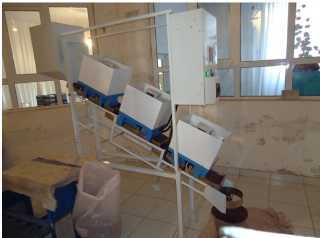
Рис. 1. Момент обработки семян облучением с помощью установки РКЭС–1
