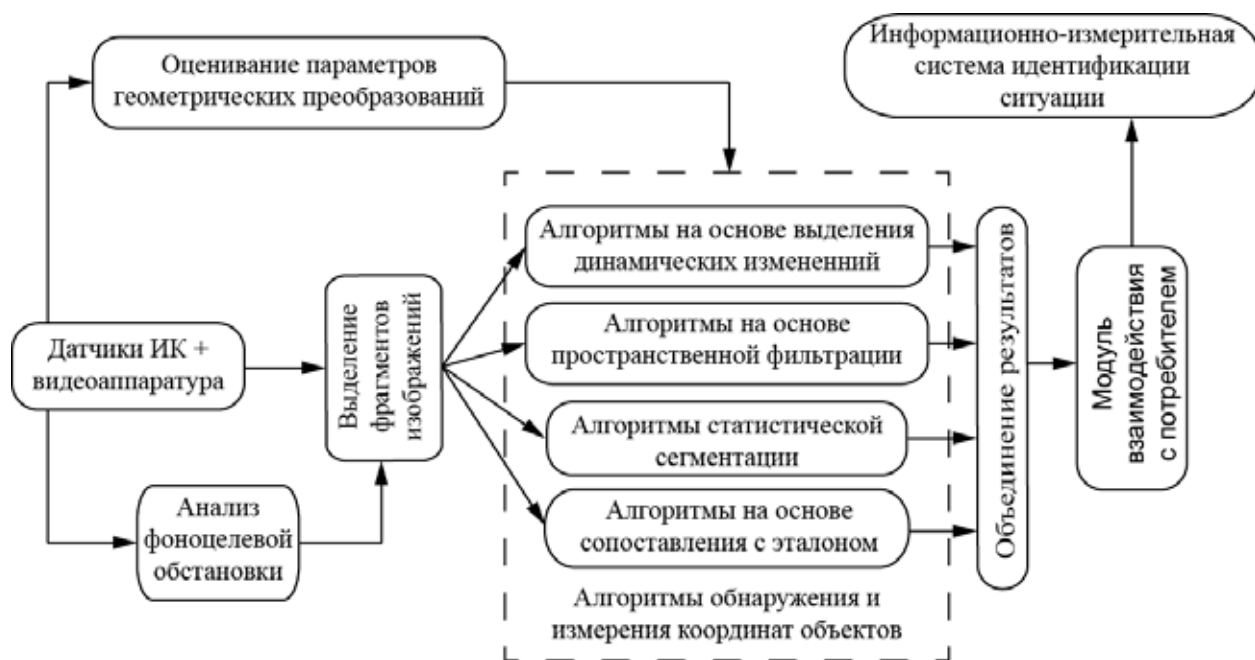
Рис. 1. Структура программно-алгоритмического обеспечения оптико-электронной системы обнаружения объектов
