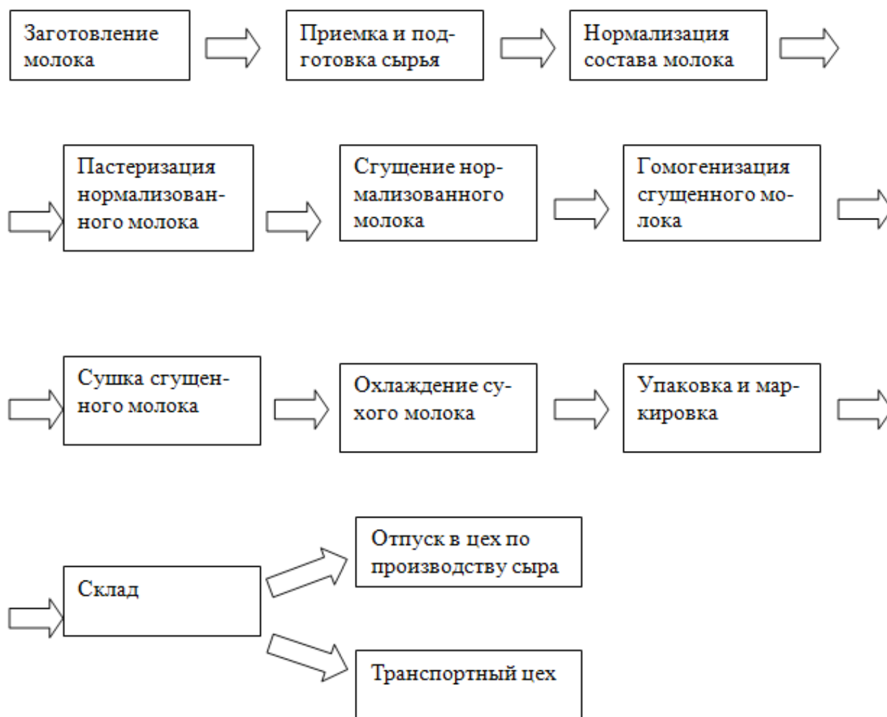
Рис. 1. Технологический процесс производства сухого молока в ОАО «Завод маслодельный Атышевский»
