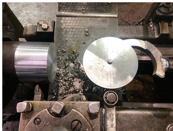
Рис. 1. Схема приспособление для обработки сферических поверхностей
