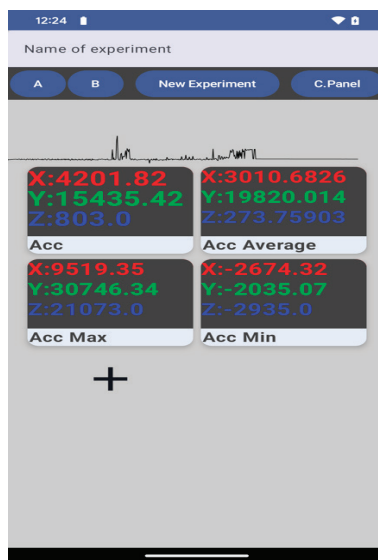
Рис. 3. Интерфейс приложения для получения и анализа данных, полученных с датчика. (На экране показывается текущее значение (Acc), Среднее значение (Acc Average) виброускорений, и соответственно их максимальное и минимальное значение)
