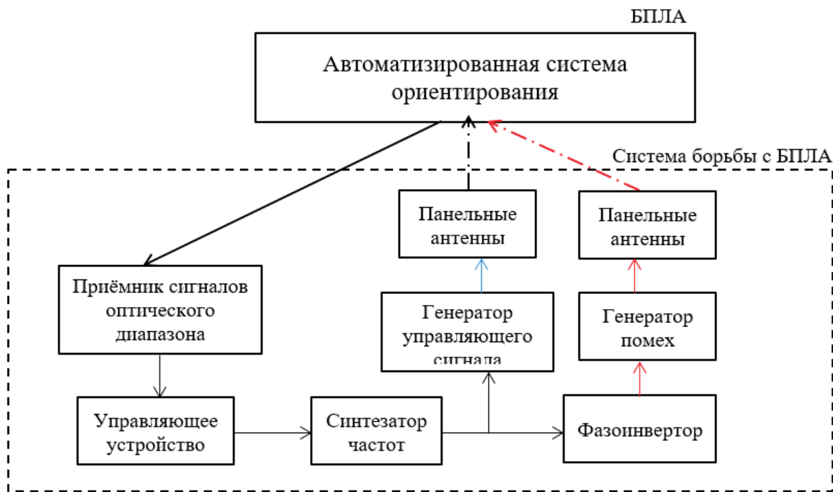
Рис. 2. Принцип работы системы борьбы с БПЛА
