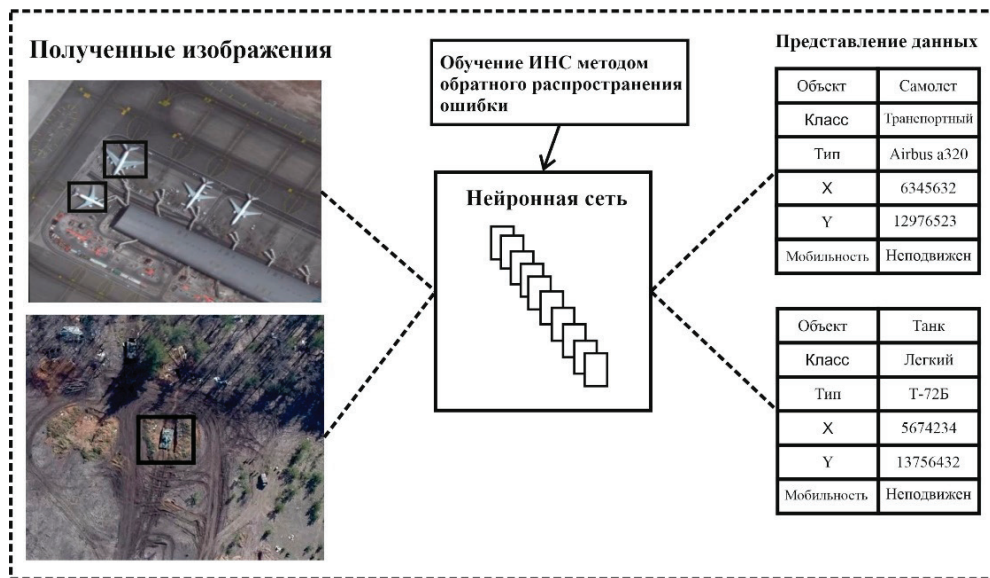
Рис. 7. Дешифрирование объектов ДЗЗ с использованием ИНС R-CNN, обученной методом обратного распространения ошибки
