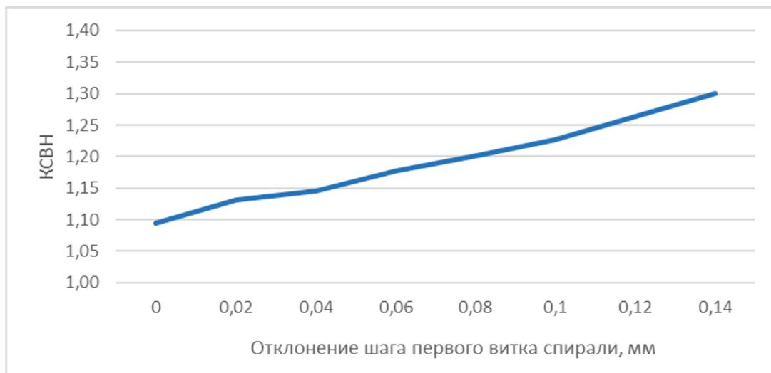
Рис. 7. Зависимость уровня КСВН от отклонения первого витка спирали
