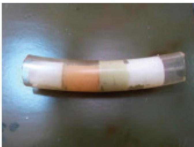
Рис. 1. Комбинация гелевых поршней SiO<sub>2</sub>(10%)-Монтмориллонит(10%)-Бентонит(5%)-SiO<sub>2</sub>(10%)
