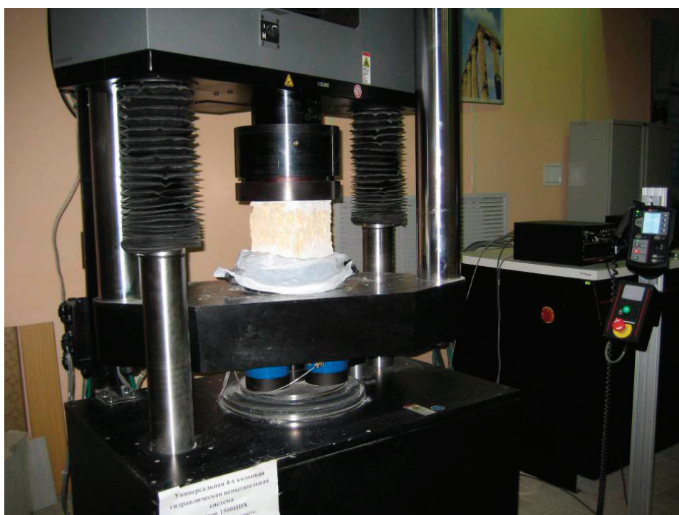
Рис. 3. Испытание крупноблочных известняковых камней на сжатие
