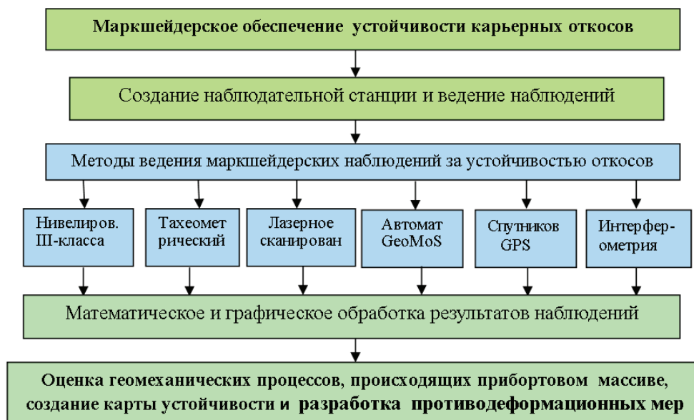
Рис. 1. Методы наблюдений за устойчивостью бортов карьера
