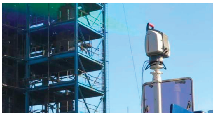
Рис. 3. Автоматизированная система наблюдении за деформациями инженерных сооружений
