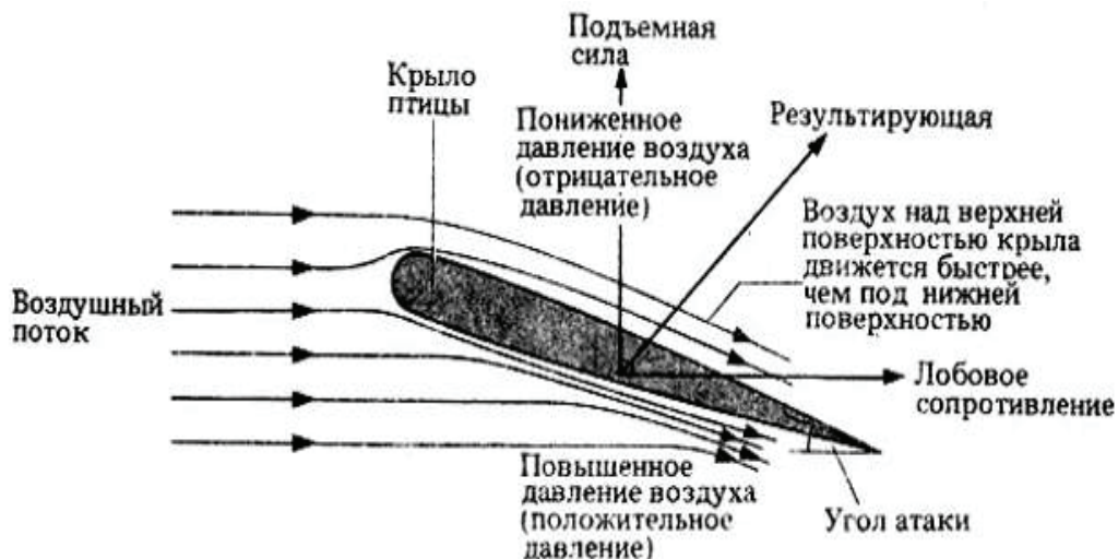
Рис. 2. Подъемная сила крыла БПЛА
