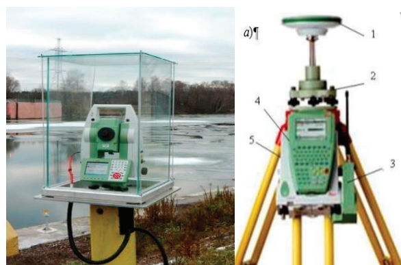
Рис. 3. Автоматизированная система наблюдении за деформациями инженерных сооружений
