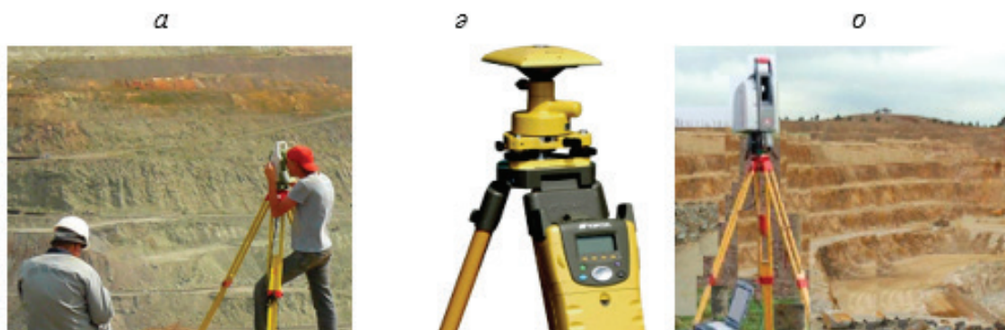
Сурет 2. Бақылау жүргізудің аспаптары
