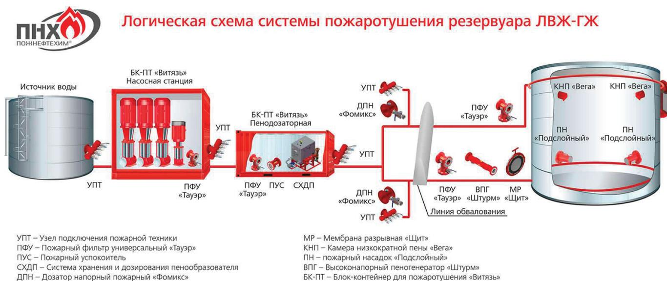
Рис. 2. Схема пожаротушения резервуаров с насосной станцией Grundfos и блоком-контейнером пожаротушения «Витязь»
