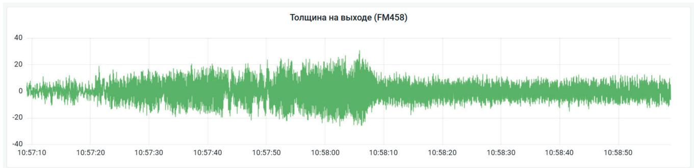
Рис. 13. Толщина полосы на выходе клетки
