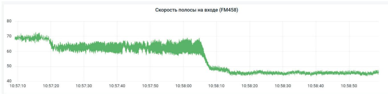
Рис. 11. Скорость полосы на входе в клеть
