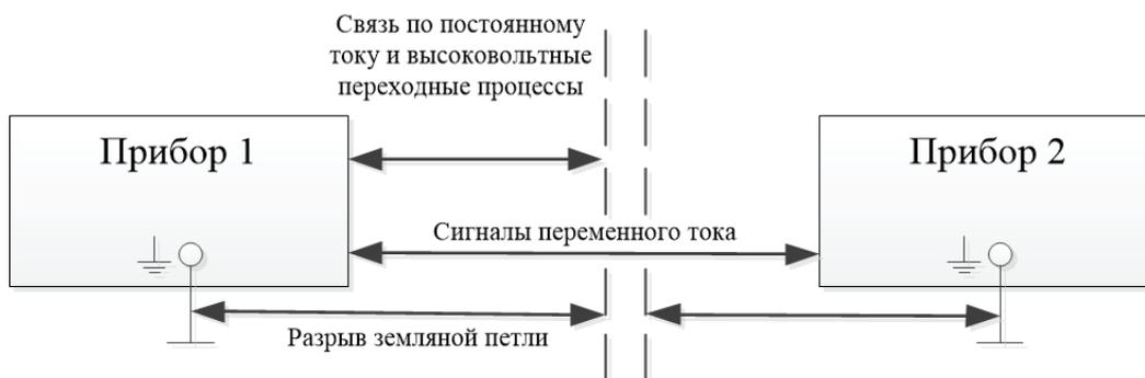
Рис. 2. Взаимодействие приборов с гальванической изоляцией
