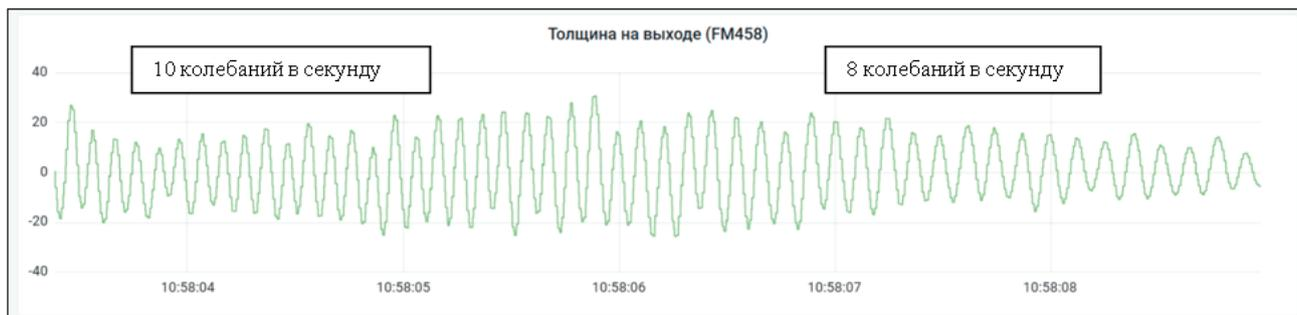
Рис. 15. Толщина полосы в зависимости от времени (частота вращения меняется)
