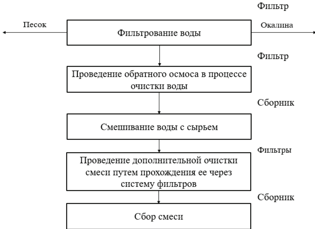
Рис. 1. Технология очистки воды
