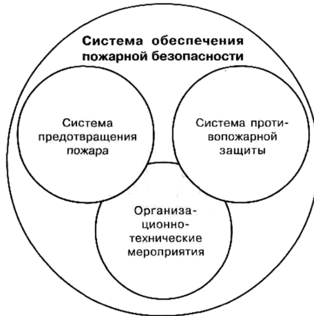
Рис. 1. Система обеспечения пожарной безопасности
