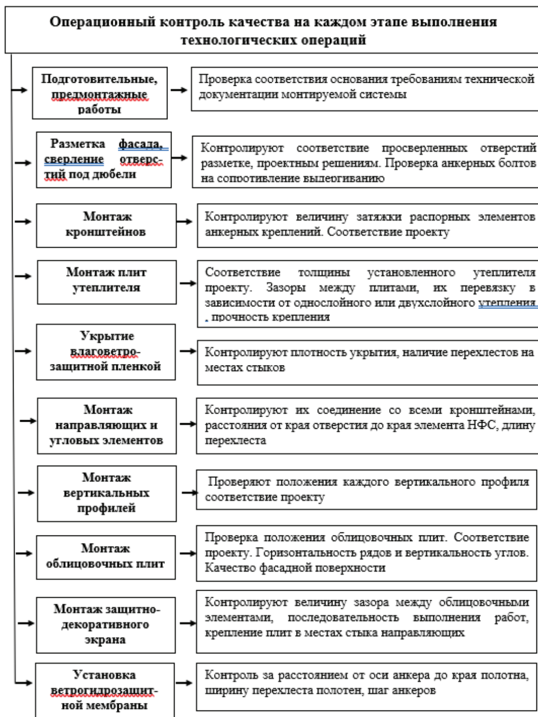
Рис. 3. Этапы выполнения технологических операций и операционный контроль качества
