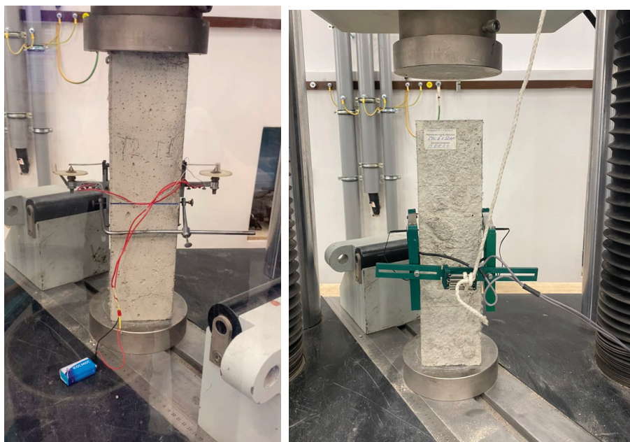
Рис. 1. Общий вид фибробетонных образцов призм в процессе испытания на сжатие
