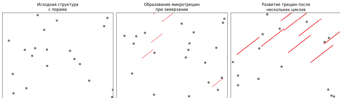
Рис. 1. Схематическое изображение механизма разрушения бетона при замораживании-оттаивании
