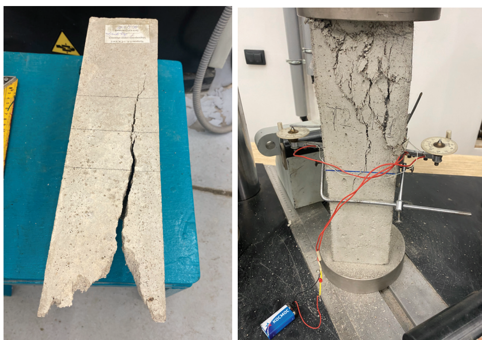
Рис. 2. Общий вид разрушенных образцов
