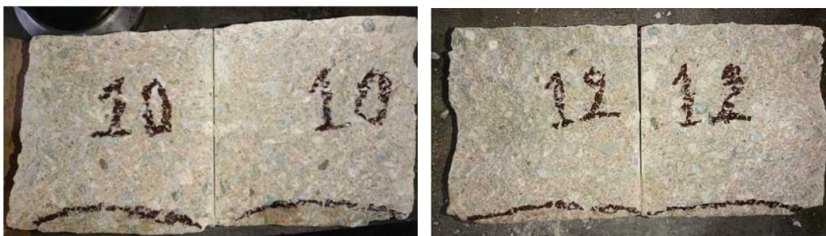
Рис. 4. Выдерживание образца с добавкой SikaControl-3760 WT в атмосфере (слева) и в воде (справа)
