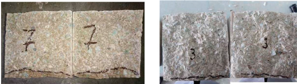
Рис. 3. Выдерживание образца с добавкой ARENA EcoMix в атмосфере (слева) и в воде (справа)
