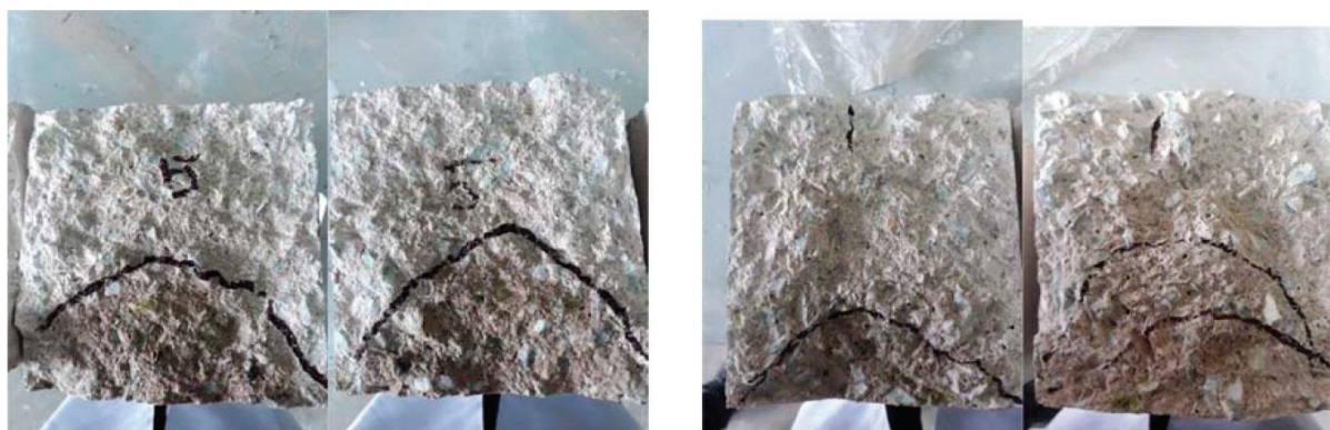
Рис. 2. Выдерживание образца без добавок в атмосфере (слева) и в воде (справа)
