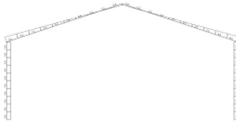
в) Этюра поперечных сил для рамы с жесткими узлами
