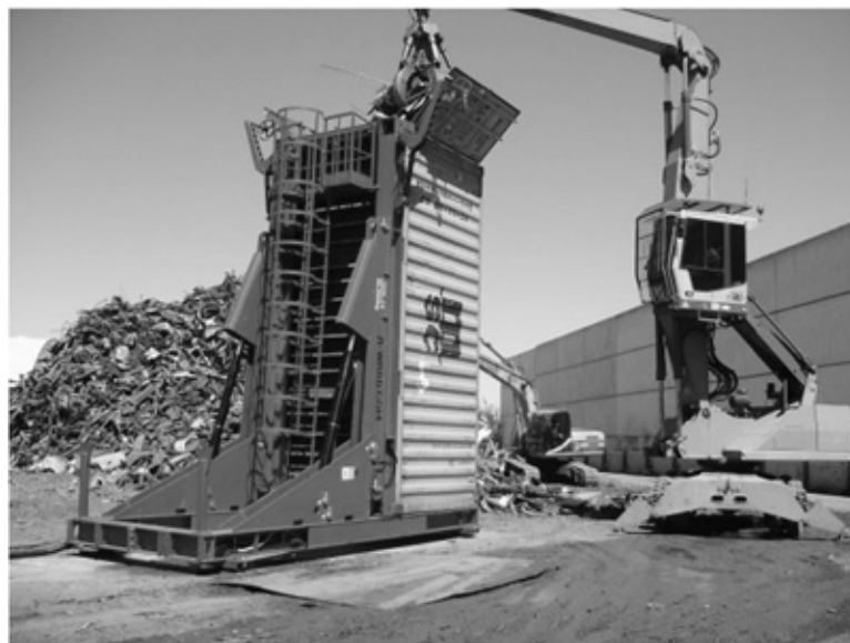
Рис. 1. Кантователь крупнотоннажных контейнеров — погрузка лома
