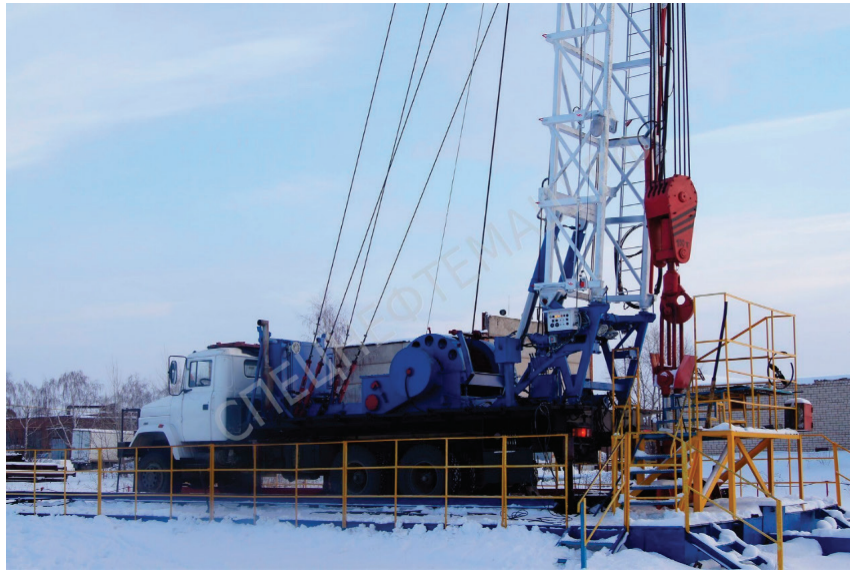
Рис. 2. Установка для освоения и ремонта скважин УПА-80
