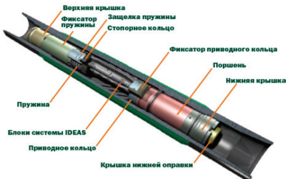
Рис. 1. Гидравлический расширитель Rhino XS
