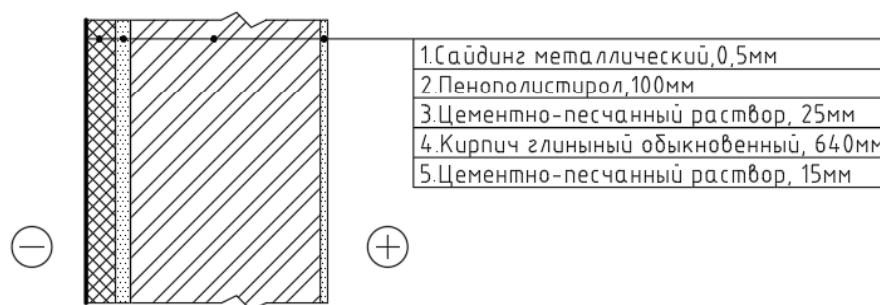
Рис. 3. Разрез конструкции наружной стены вариант 2
