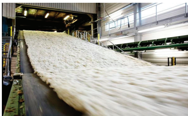
Рис. 4. Конвейерная линия транспортировки первичного ковра
