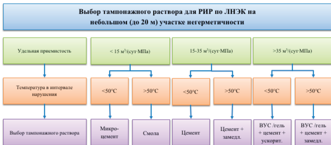
Рис. 2. Алгоритм выбора тампонажного состава для РИР
