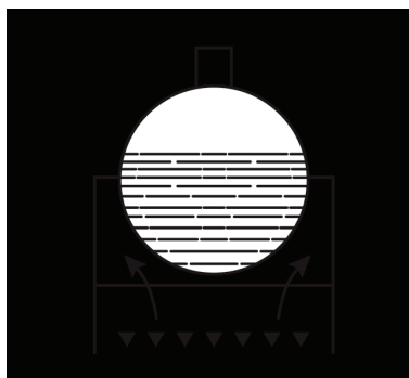
Рис. 1. Цилиндрический котел с внешней топкой
