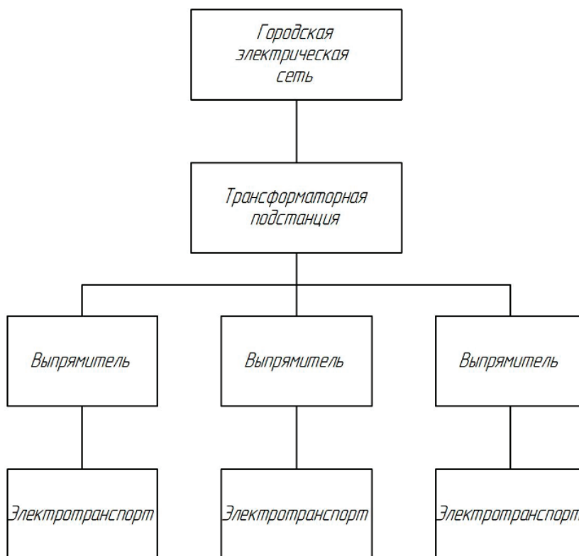
Рис. 3. Блок-схема системы электроснабжения зарядных станций для электротранспорта
