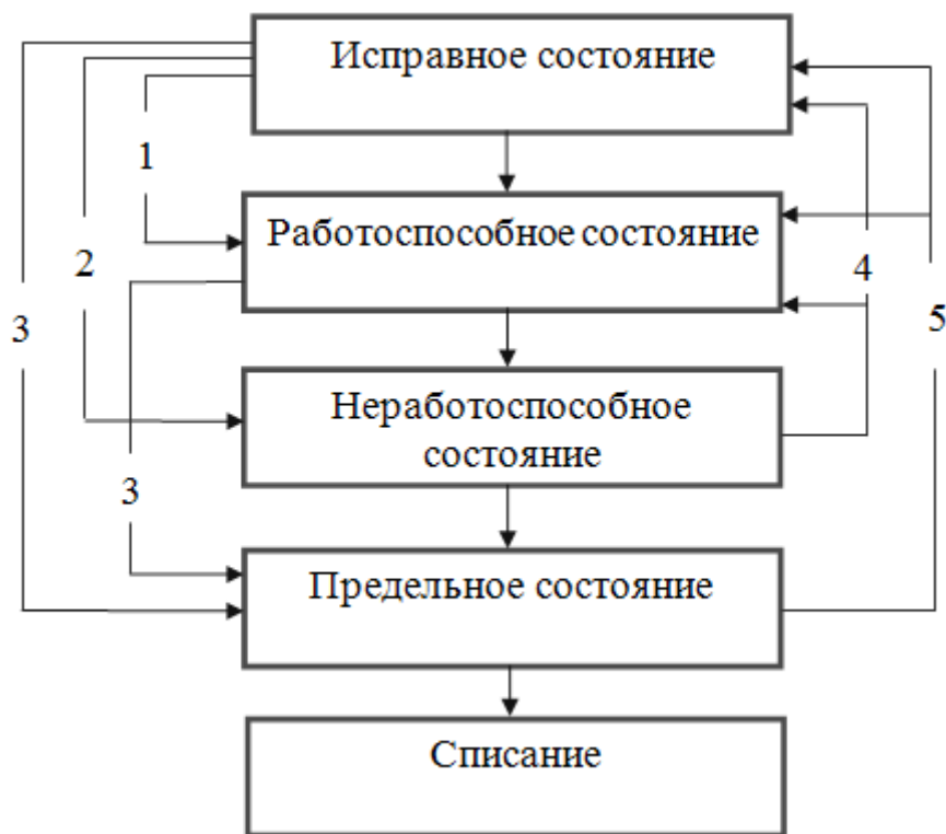
Рис. 1. Схема постоянных состояний и событий объектов: 1 — повреждение; 2 — отказ; 3 — переход объекта в предельное состояние; 4 — восстановление; 5 — ремонт
