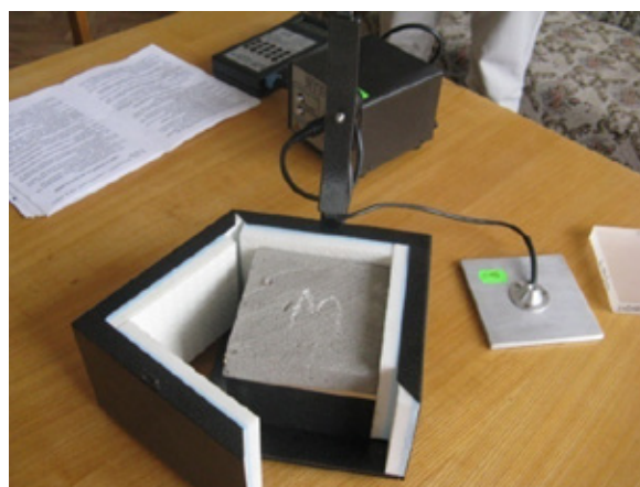
Рис. 2. Установка образца торкрет-бетона в установку ИТП МГ-4
