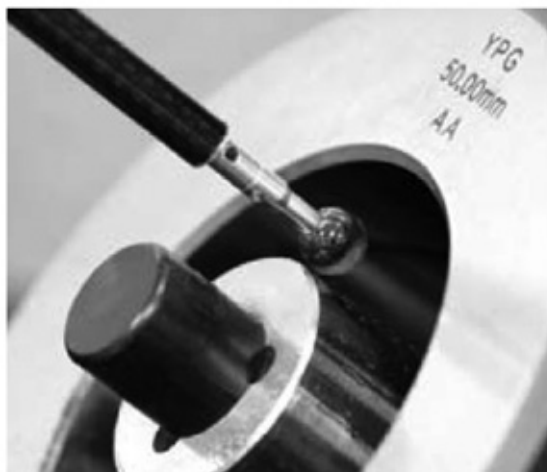
Рис. 1. Выполнение контактных измерений с помощью щупа
