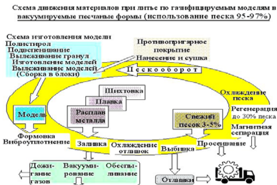
Рис. 2. Эмпирическая схема движения материалов при литье по газифицированным моделям
