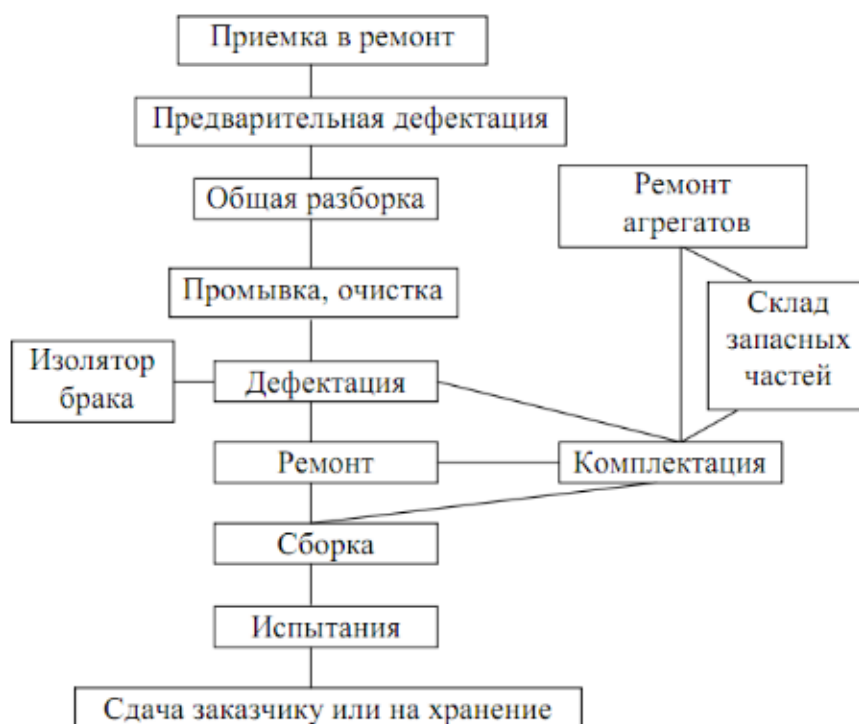
Рис. 1. Этапы технологического процесса ремонта ЛА
