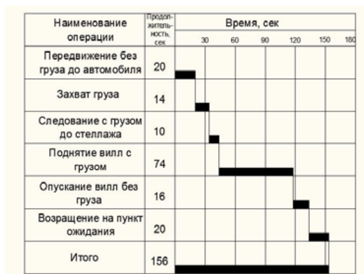
Рис. 6. Примерный график рабочего цикла при переработке европоддонов самоходным штабелером
