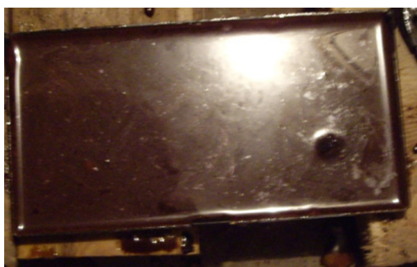
Рис. 10. Ванна с FeCl_3 , в процессе вытравки платы
