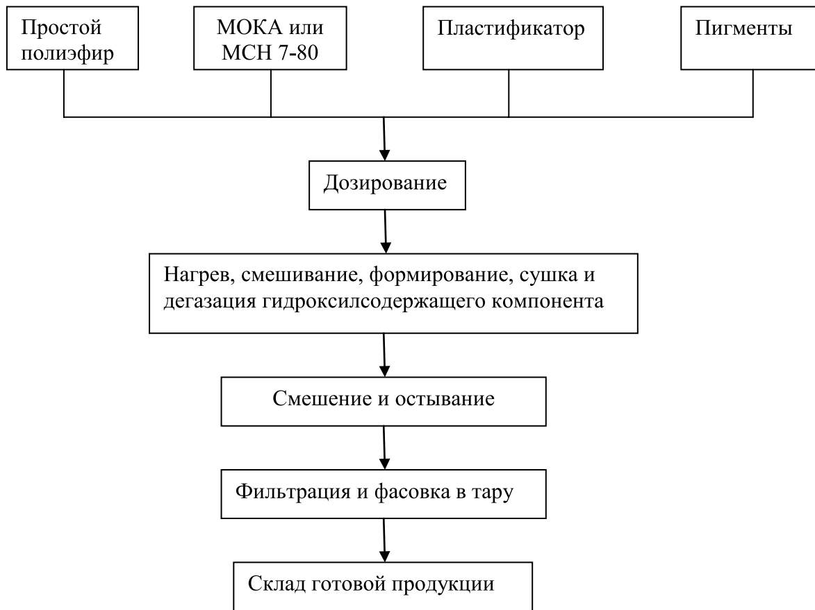
Рис. 1. Технология производства гидроксилсодержащего компонента покрытия
