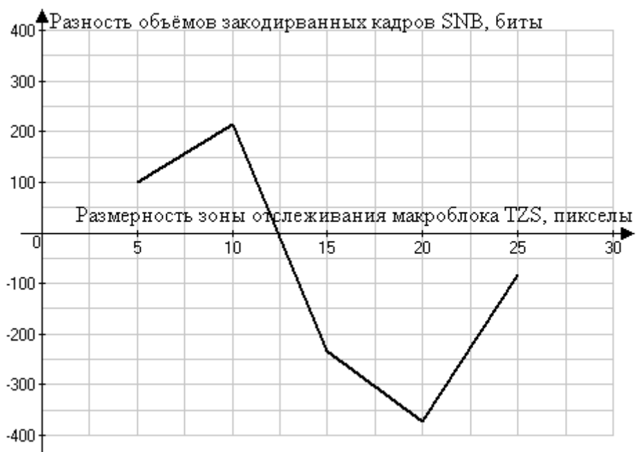
Рис. 3. Зависимость объема закодированной информации от режима задания границ зоны отслеживания макроблока
