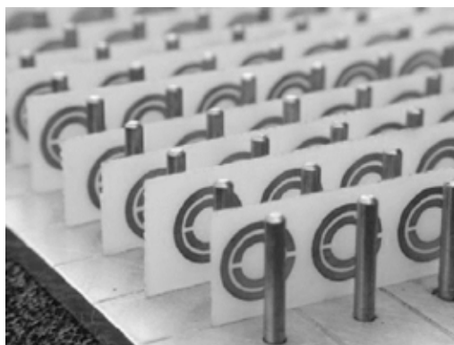
Рис. 6. Экспериментальный образец DNG-метаматериала
