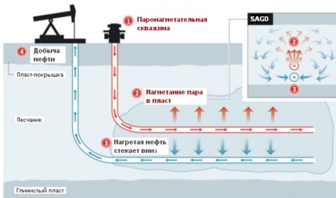
Рис. 2. Технологи добычи тяжелой нефти SAGD
