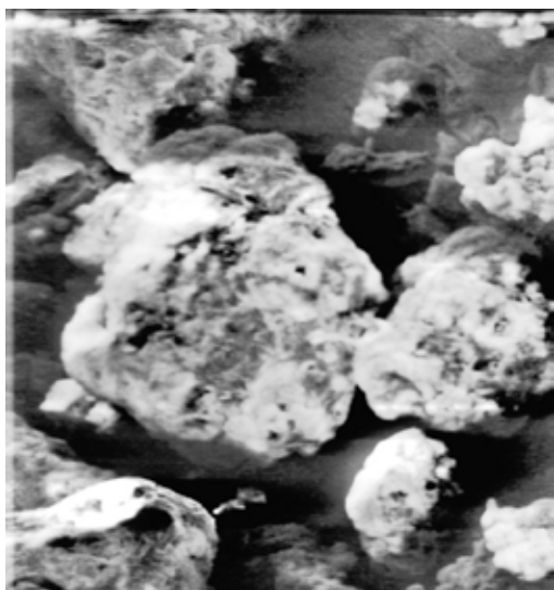
Рис. 1. Электронно-микроскопический снимок сополимера АН-ГТТ, обработанный 2 часа толуолом. Увеличение 180 раз
