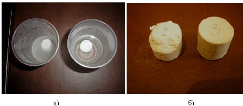
Рис. 2. Негидрофобизированный размучившийся в воде (слева) и гидрофобизированные (справа) образцы из прессованного порошка мрамора; а) — в процессе водонасыщения; б) — после водонасыщения
