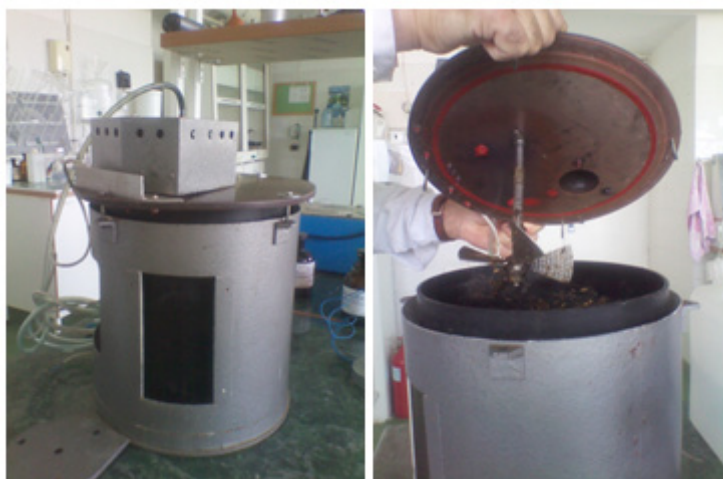
Рис. 1. Лабораторная биогазовая установка
