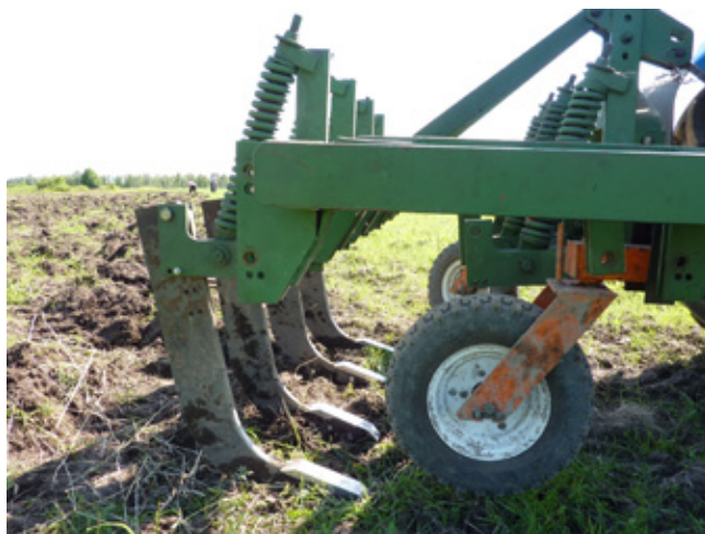
Рис. 2. Расположение рабочих органов в 1 ряд (угол атаки рабочих органов 81°, вид справа)
