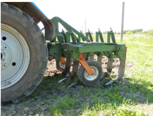
Рис. 1. Общий вид агрегата МТЗ-920+УКПА-2,4 для глубокого рыхления почвы (угол атаки рабочих органов 90°)
