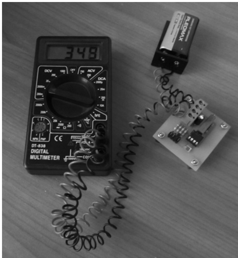
Рис. 2. Демонстрация того, как датчик переводит единицы освещенности в единицы электрического напряжения
