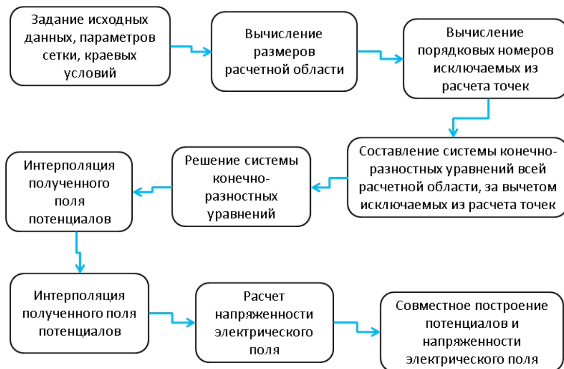
Рис. 4. Блок-схема алгоритма к расчету напряженности поля несимметричного конденсатора
