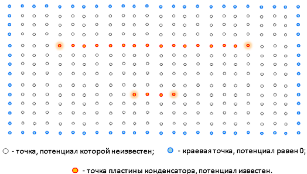
Рис. 3. Расчетная область плоского несимметричного конденсатора
