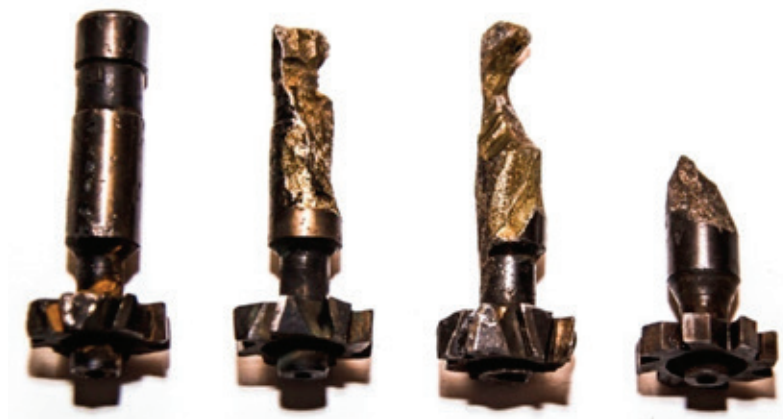
Рис. 5. Стадии разрушения металлического образца отходов БРС при проведении нескольких процессов ЭЭД
