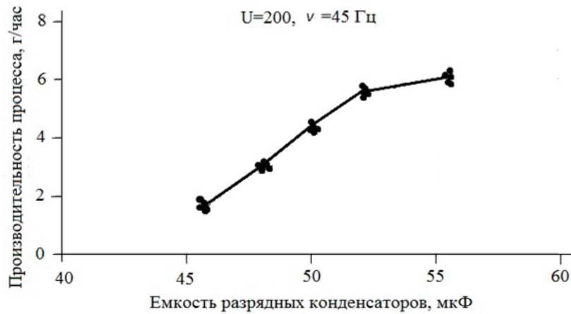
Рис. 3. Зависимость производительности процесса от емкости разрядных конденсаторов установки ЭЭД
