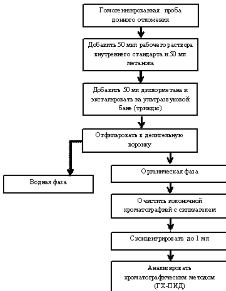
Рис. 3. Схема подготовки и анализа образцов донных отложений на ГХ-ПИД
