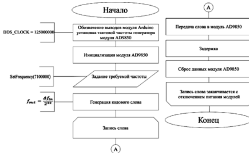
Рис. 3. Блок-схема алгоритма управления модулем AD9850
