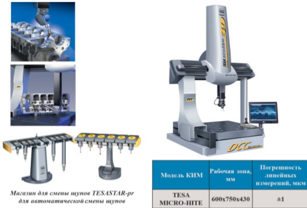
Рис. 5. Компактные координатно-измерительные машины TESA MICRO-HITE
