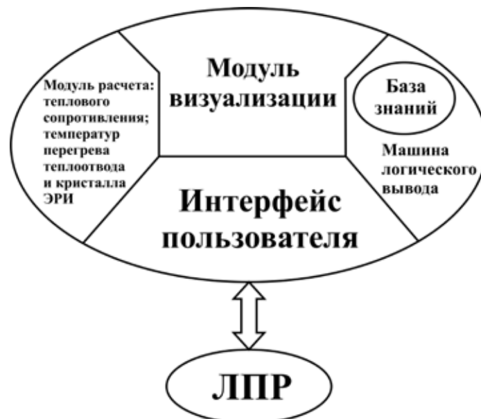
Рис. 1. Структура СППР в области выбора радиатора ЭРИ
