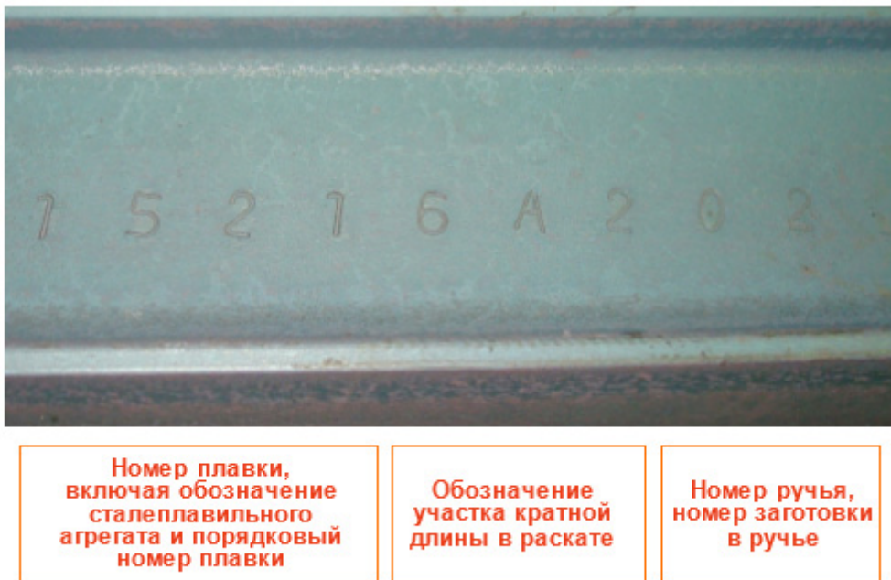
Рис. 3. Пример маркировки, нанесенной клеймовочной машиной RSM 20/5
