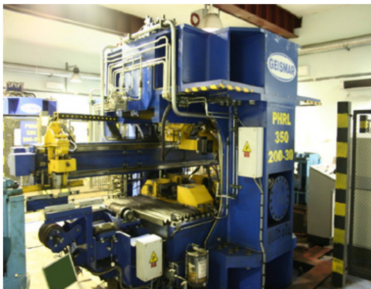
Рис. 5. Гидравлический правильный пресс PHRL 350/20030
