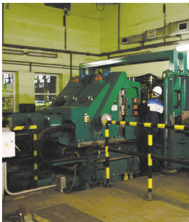
Рис. 6. Сверлильно-отрезной станок типа SSB 700 E55/60
