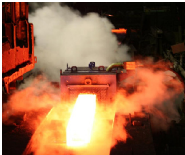
Рис. 1. Установка гидросбива окалины
