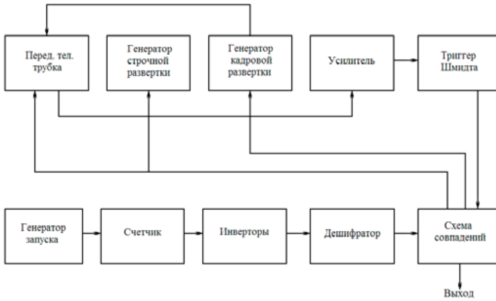
Рис. 1. Структурная схема фотоэлектронной системы считывания знаков
