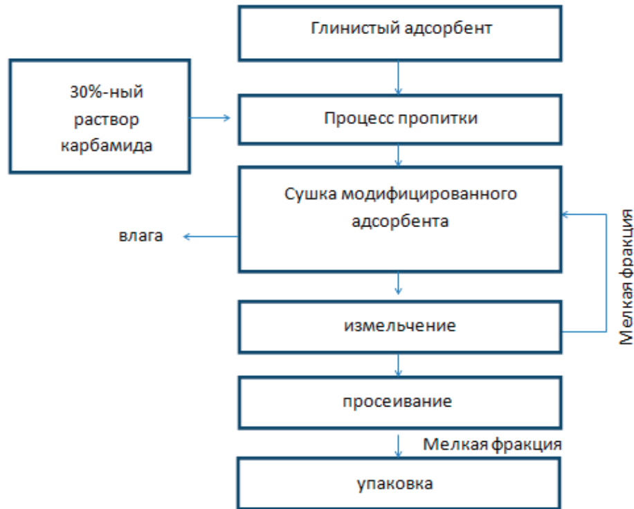
Рис. 1. Блок-схема получения модифицированных карбамидом глинистых адсорбентов для глубокой депарафинизации минеральных масел
