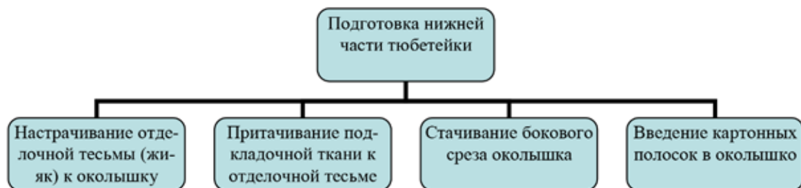
Рис. 5. Схема технологического процесса подготовка нижней части тюбетейки
