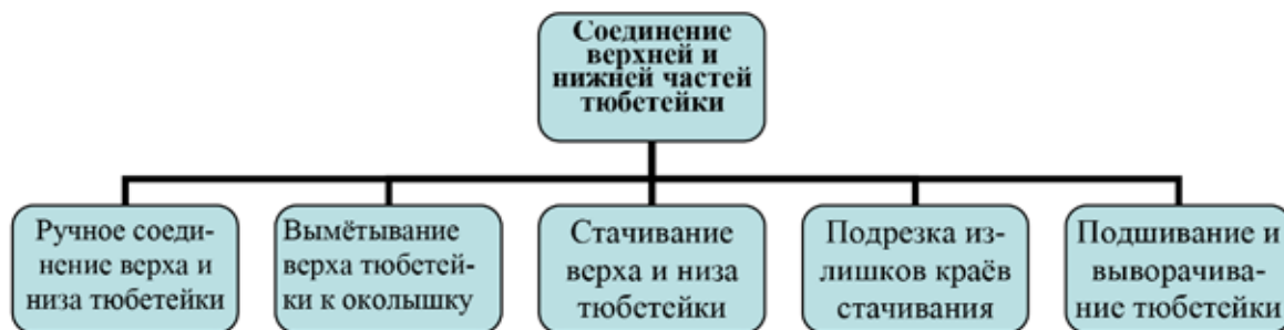
Рис. 6. Схема технологического процесса соединения деталей тюбетейки
