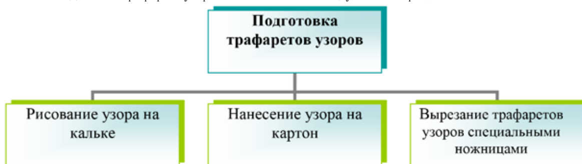
Рис. 4. Схема технологического процесса подготовка трафаретов узоров
