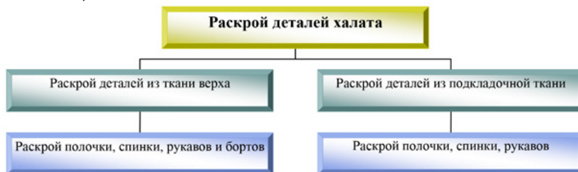
Рис. 3. Схема технологического процесса раскроя деталей халата
