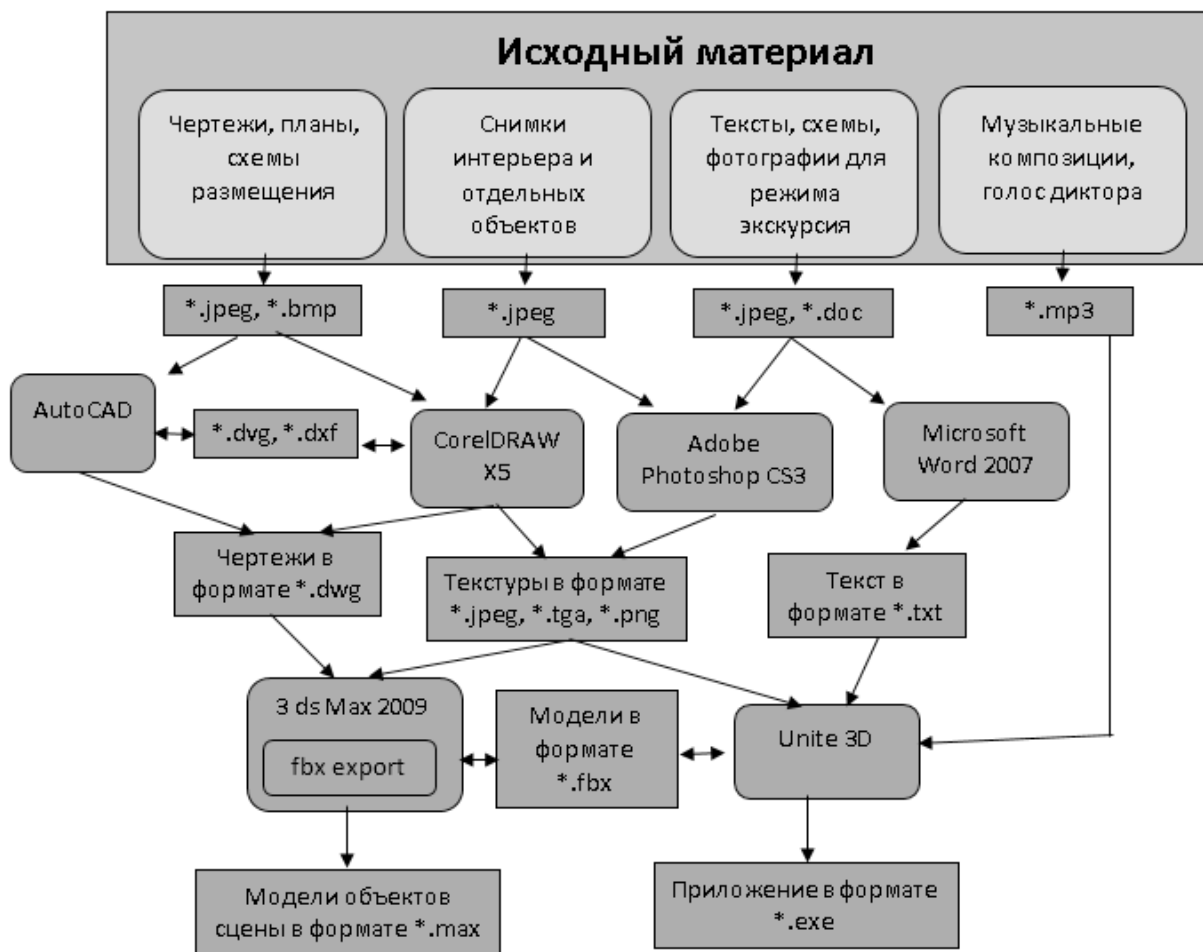
Рис. 2. Схема взаимодействия программных средств, необходимых для разработки приложения подготовки и управления спектаклем
