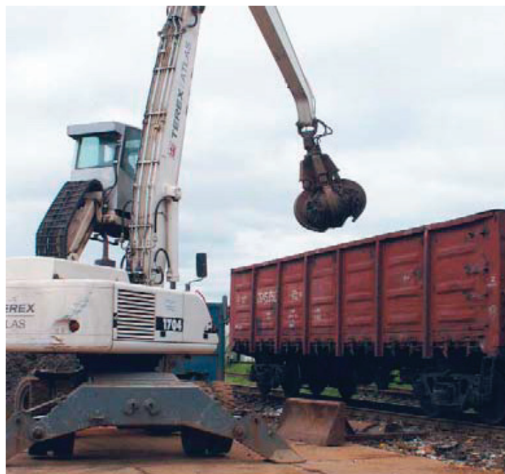
Рис. 3. Погрузка лома в полувагон колесным экскаватором (с подъемной кабиной)
