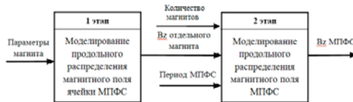
Рис. 2. Два этапа моделирования продольного распределения магнитного поля всех видов МПФС
