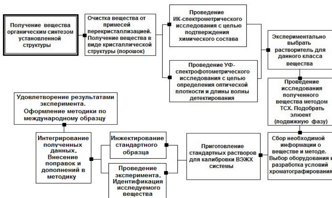
Рис. 5. Пооперационная схема технологии проведения эксперимента, способствующего созданию методики идентификации исследуемого вещества методом ОФ-ВЭЖХ-УФ
