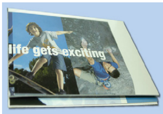
Рис. 1. Результат процесса каширования: мелованная бумага с отпечатанным изображением приклеена к картону
