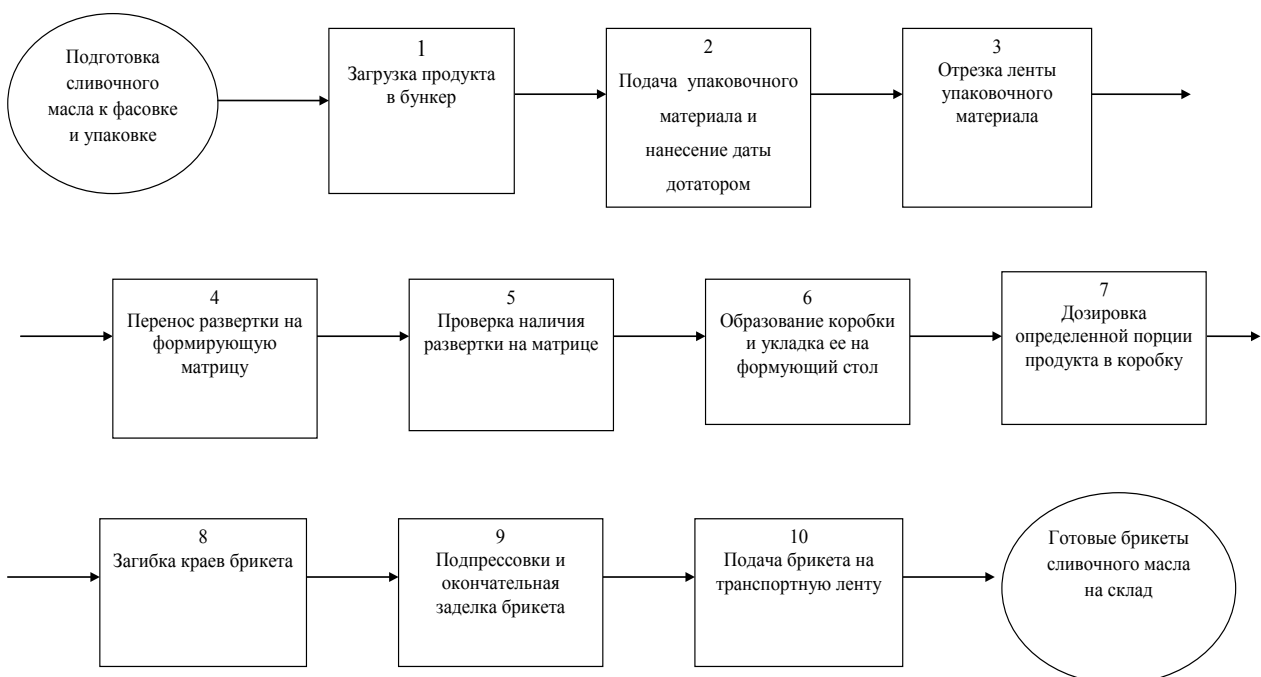
Рис. 3. Технологическая схема упаковки маслodelьных продуктов в кашированную фольгу
