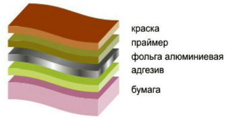
Рис. 2. Слои кашированной фольги
