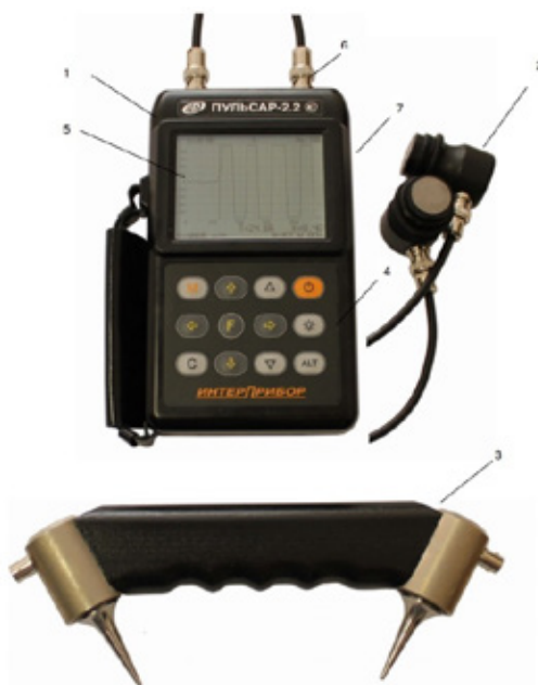
Рис. 4. Общий вид прибора «ПУЛЬСАР-2.2» [1]: 1-электронный блок; 2-датчики сквозного прозвучивания; 3-датчики поверхностного прозвучивания; 4-клавиатура; 5-графический дисплей; 6-разъёмы для датчика поверхностного прозвучивания; 7-USB-разъём
